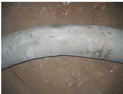
图 2 \Phi 324\text{ mm} \times 7\text{ mm} 纯钛管热弯试样
