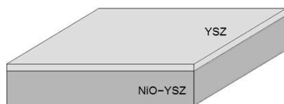
图 1 阳极支撑固体氧化物燃料电池半电池结构
