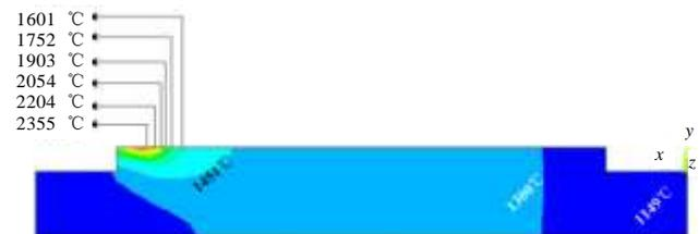
图 3 激光沉积试样温度场分布
