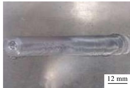
图 1 FSW 焊缝表面的宏观形貌
