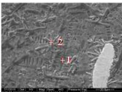
图 3 2000 W 下熔覆层显微形貌
