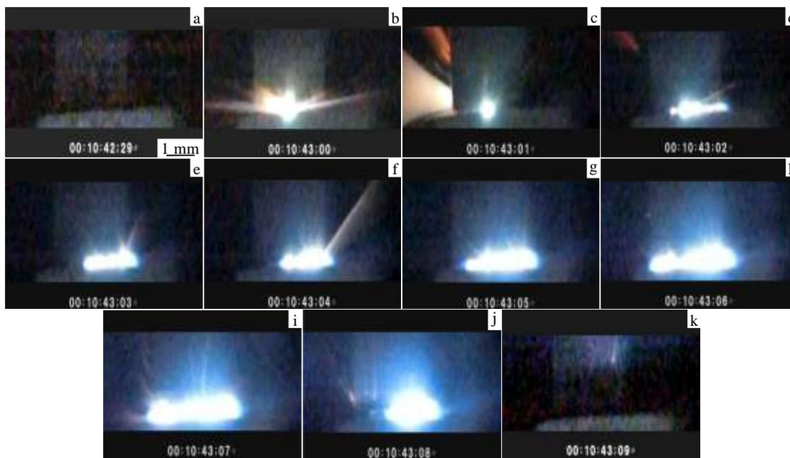
图 3 AgWC30 触头在 25 A, 25 V 条件下电弧形貌
