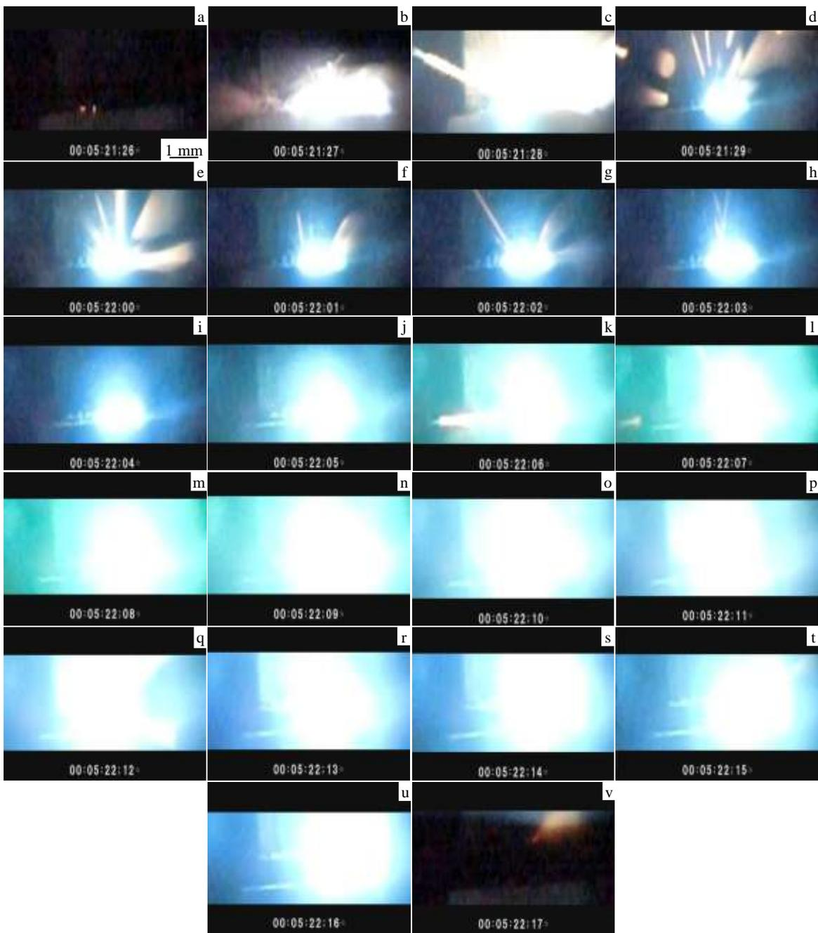
图 5 AgWC30 触头在 25 A, 35 V 条件下电弧形貌
