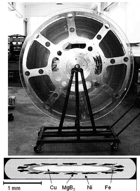
图 3 INFM 公司生产出的 1600 m 长线材
