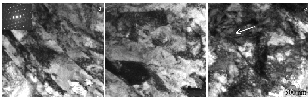
图 5 工业纯锆单道次 ECAP 变形后 Y 面的 TEM 照片
