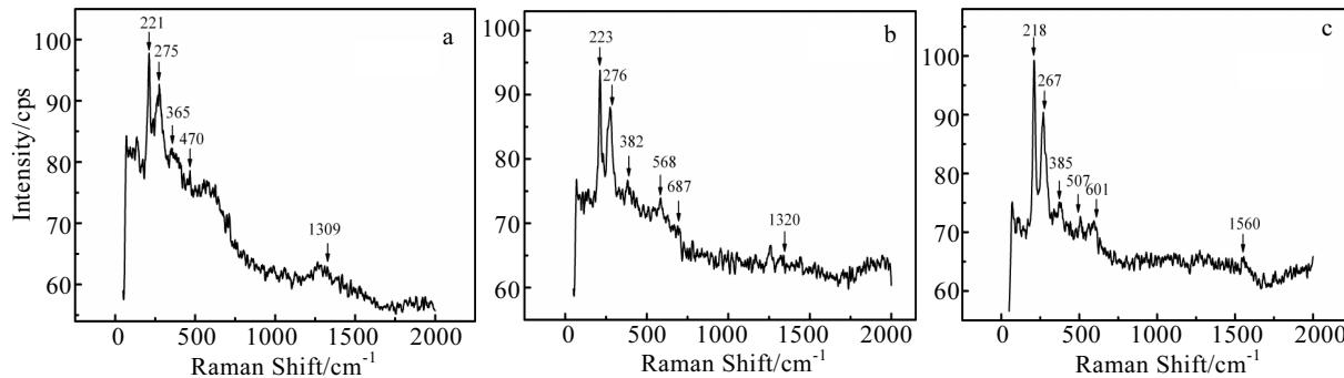
图 4 NdFeB 试样不同腐蚀时期的拉曼光谱测试结果
