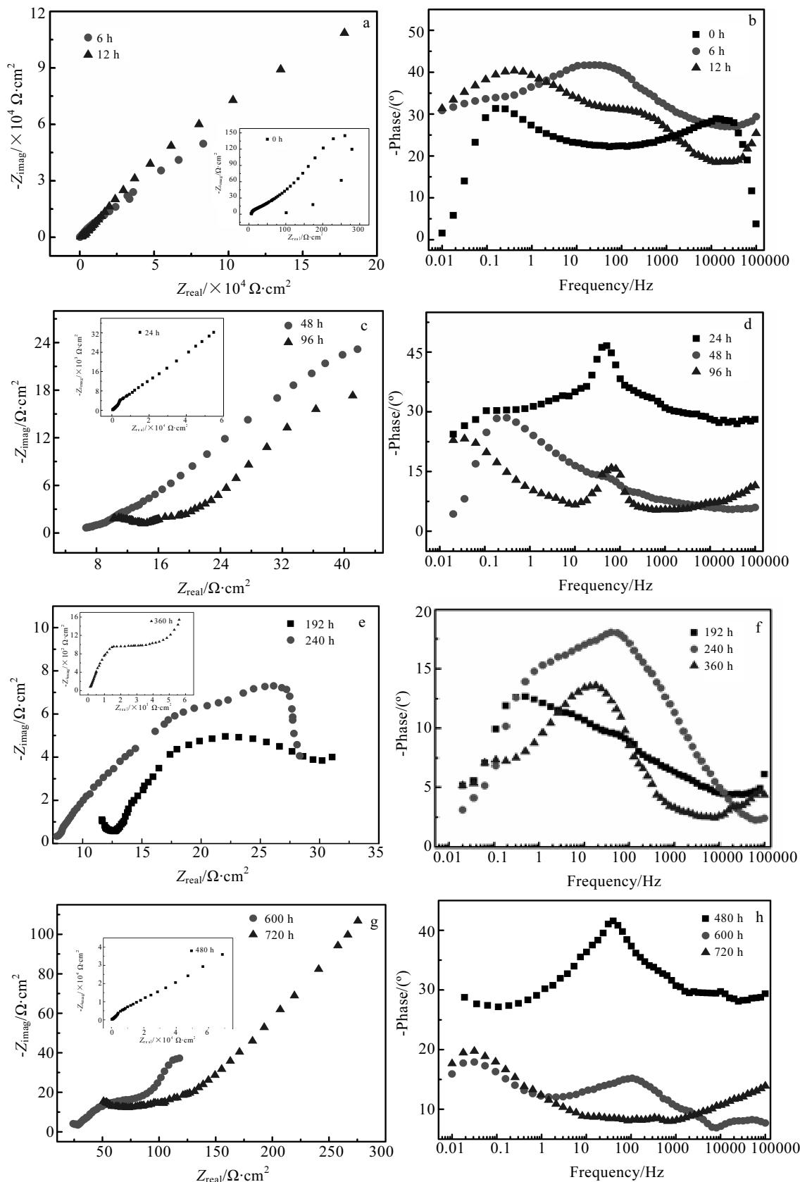
图 6 NdFeB 试样浸泡不同时间的交流阻抗谱
