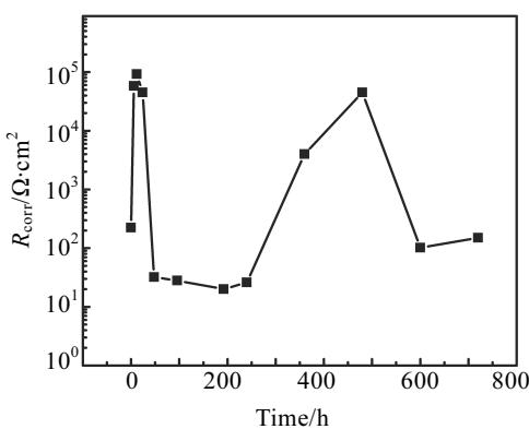
图 9 NdFeB 试样不同腐蚀时间的腐蚀电阻  $R_{corr}$
