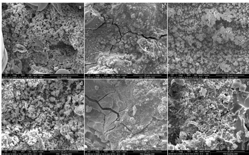
图 3 NdFeB 试样浸泡不同时间后的表面微观腐蚀形貌
