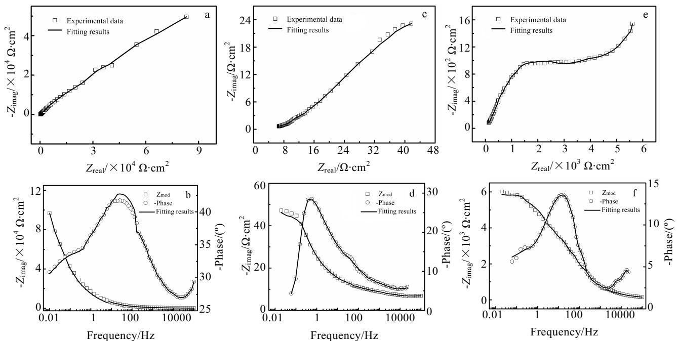
图 8 NdFeB 试样不同腐蚀阶段的拟合结果与实测阻抗谱
