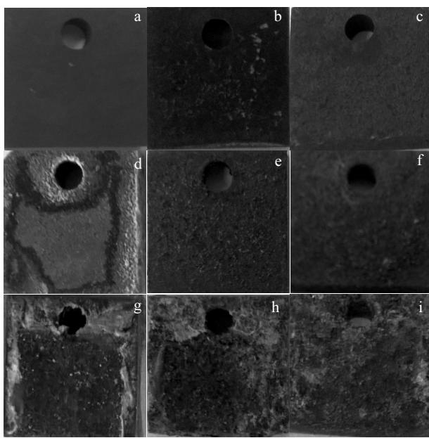
图 2 NdFeB 试样浸泡不同时间的宏观照片
