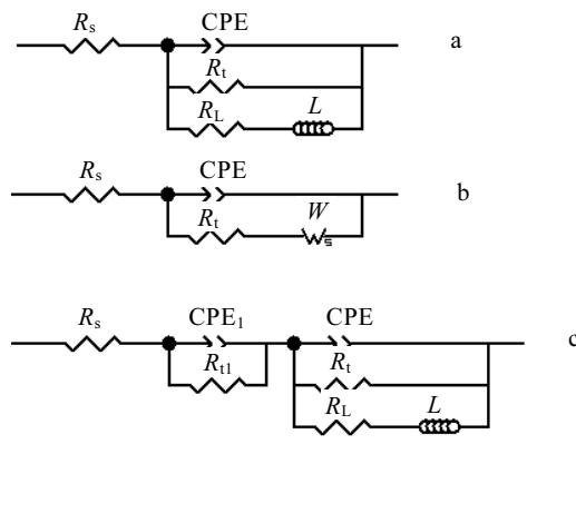
图 7 NdFeB 试样不同腐蚀阶段的等效电路图
