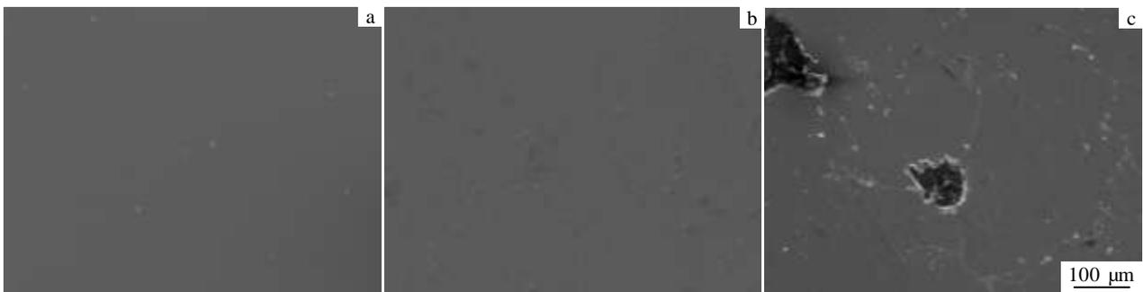
图 5 G3 合金在不同温度下经电化学阻抗谱测试后形貌
