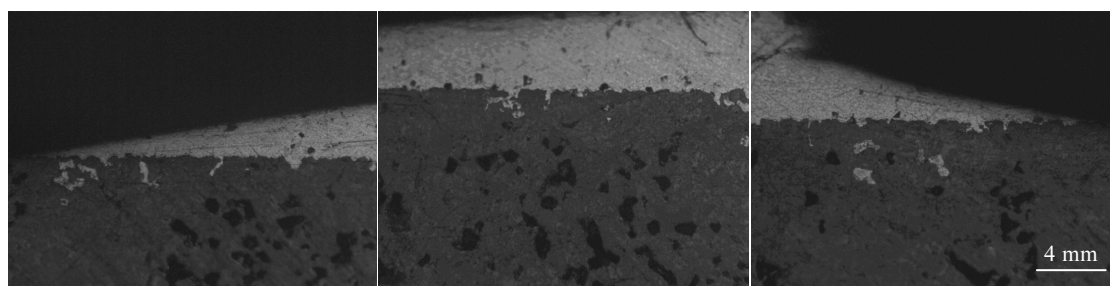
图7 超声波作用5 s时钎料与石墨界面形貌
