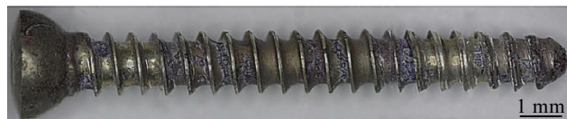
图 9 新型镁合金骨钉降解 360 h 后概貌
