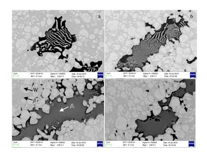
图 3 不同 TiH<sub>2</sub> 配比的预混粉末经热压烧结后的 SEM 照片
