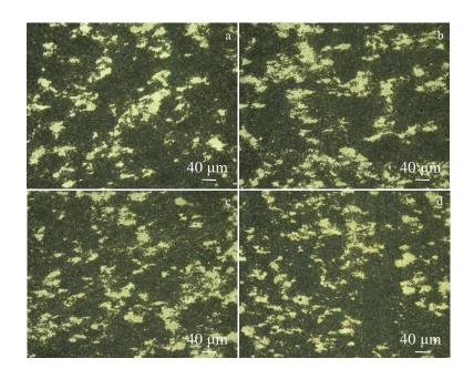
图 2 不同 TiH<sub>2</sub> 配比的预混粉末经热压烧结的微观组织
