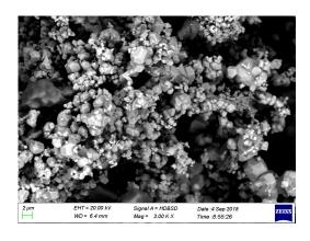
图 1 W-Ti 混合粉末形貌
