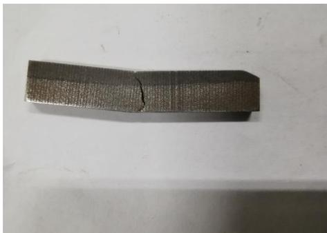
图 13 三点弯曲测试后 TiB<sub>2</sub>/42CrMo 功能梯度材料试样
