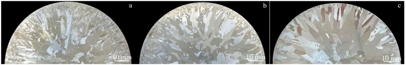
图 7 3 种 Zr 含量均匀化态铸锭的晶粒形貌
