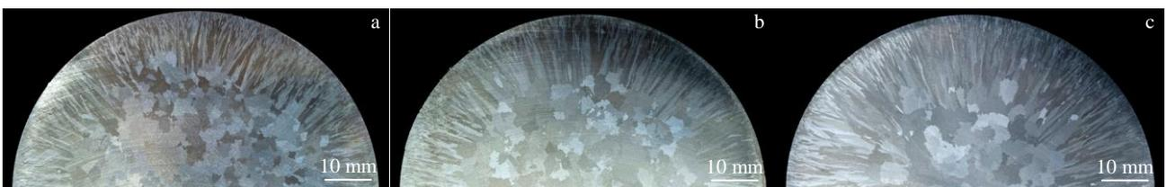
图 1 3 种不同 Zr 含量铸锭的原始晶粒形貌
