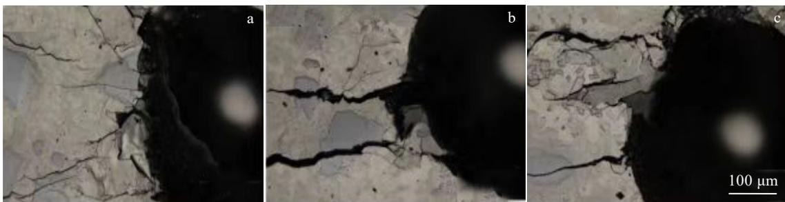
图 10 1470 N 载荷下不同 WC 含量的钎涂层显微组织
