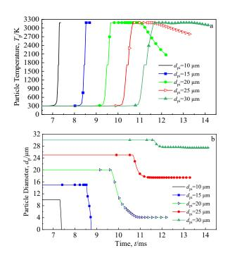
图 6 具有不同初始粒径的镍粉颗粒的颗粒温度  $T_p$  及粒径  $d_p$  随时间变化的曲线
