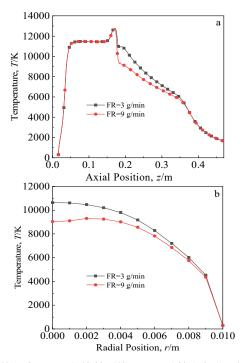
图 10 粒径为 15 μm 的镍粉颗粒以不同送粉速率进入等离子体 炬后等离子体温度沿轴向及径向 r=0.19 m 位置处分布 的曲线图
