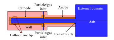
图 1 直流电弧等离子体炬装置的结构示意图
