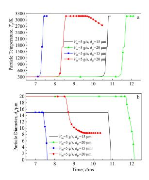
图 7 不同工作气体质量流量下初始粒径  $d_{pi}$ 分别为 15 和 20  $\mu$ m 时镍粉温度  $T_p$  及粒径  $d_p$  随时间变化曲线
