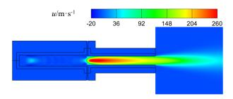
图 3 直流电弧等离子体的速度分布
