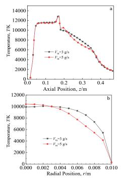
图 8 不同工作气体质量流量下等离子体温度沿轴向及径向 r=0.19 m 位置处分布的曲线图
