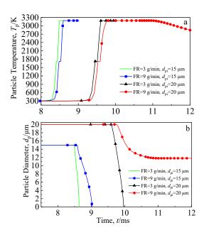
图 11 不同送粉速率下初始粒径  $d_{pi}$ 分别为 15 和 20  $\mu$ m 时镍粉 颗粒温度  $T_p$  及粒径  $d_p$  随时间变化的曲线
