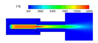
图 2 直流电弧等离子体的温度分布
