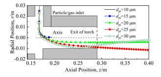
图 5 具有不同初始粒径的镍粉颗粒在空间中的运动轨迹
