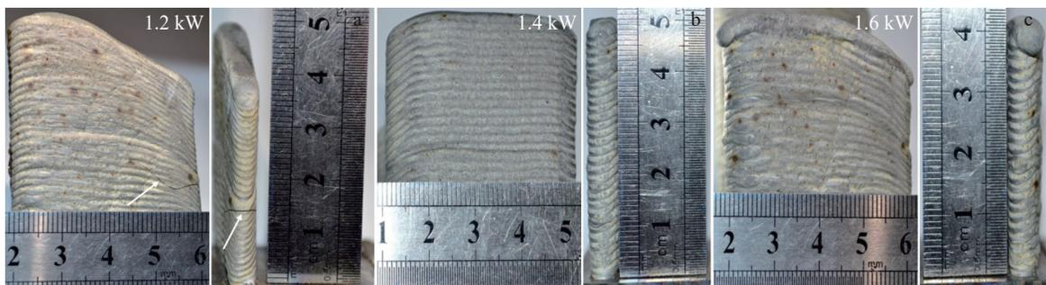
图 2 激光熔化沉积 Ti-48Al-2Cr-2Nb 合金试样宏观形貌
