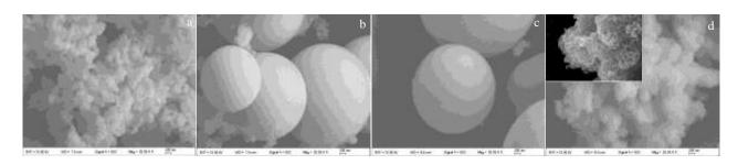
图 2 不同反应时间制得的 SnO<sub>2</sub> 实心微球 SEM 照片
