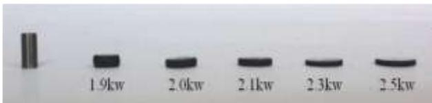
图 7 置氢 0.65% TC16 钛合金磁脉冲冷镦试样
