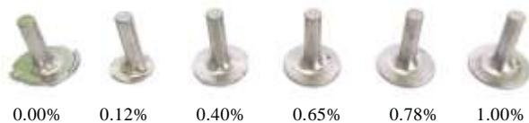
图 9 不同氢含量坯料冷墩 TM5 托板螺母外观图
