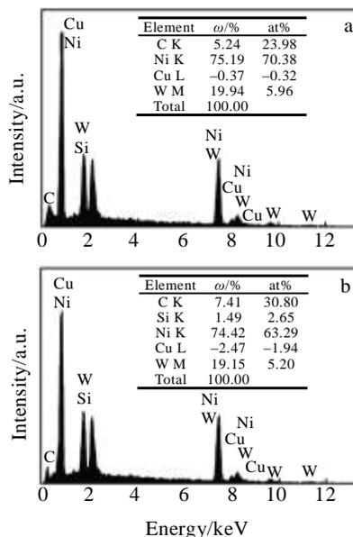
图 4 Ni-W 和 Ni-W/SiC 镀层 EDS 能谱图
