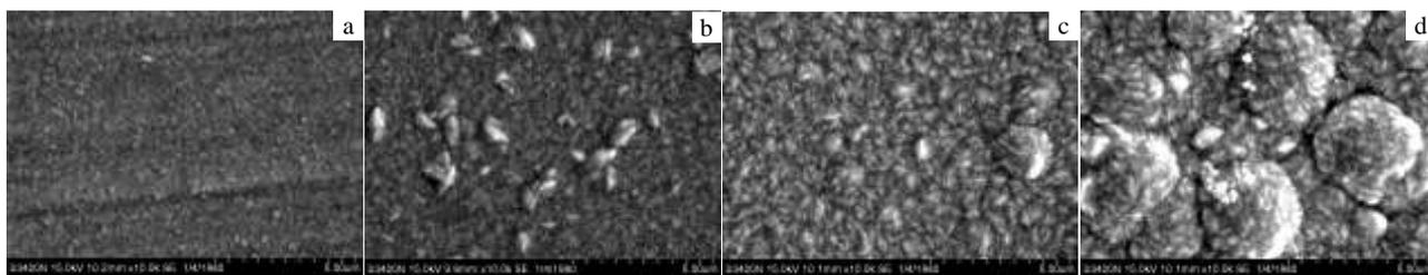
图 3 不同沉积时间 Ni-W/SiC 复合镀层形貌
