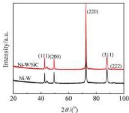
图 5 合金镀层的 XRD 图谱
