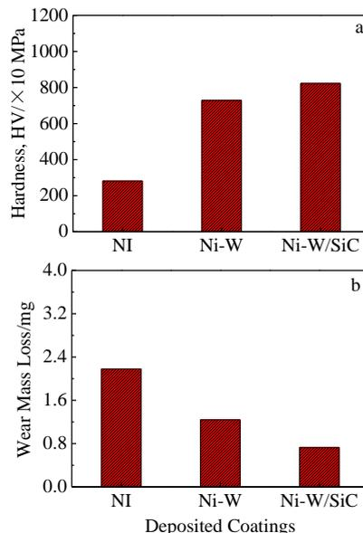
图 6 不同涂层的硬度及磨损失重
