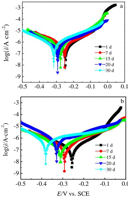
图 8 镀层在 3.5%NaCl 溶液中浸泡不同时间的 Tafel 曲线
