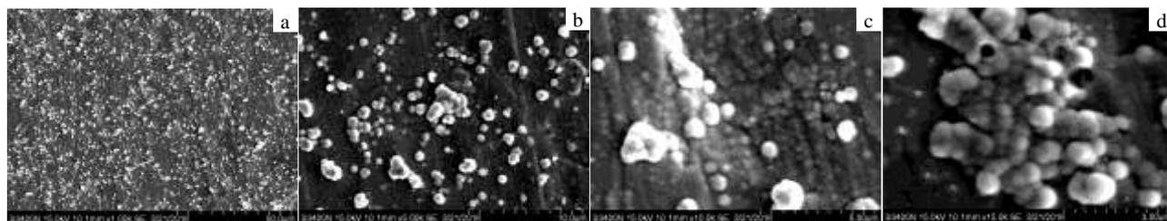
图 2 不同放大倍数的 Ni-W/SiC 复合镀层形貌
