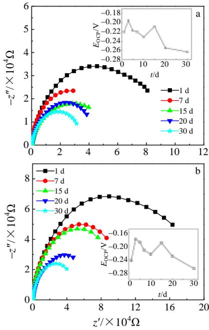
图 7 镀层在 3.5% NaCl 溶液浸泡不同时间的 EIS 图谱
