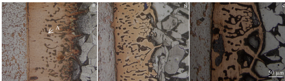
图 5 不同温度下含 Cu-2%Cr 夹层的铜钨/20 钢界面组织
