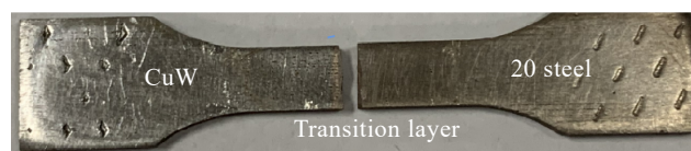
图 10 铜钨/20 钢整体材料拉伸断口位置
