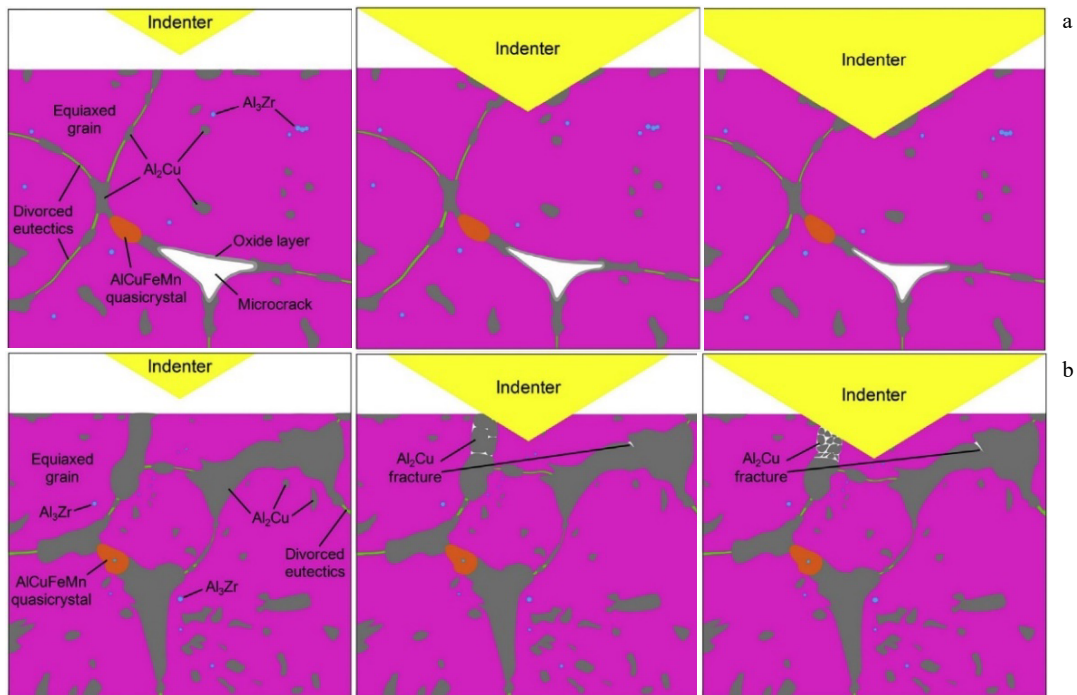
图 13 焊缝细晶区的局部弱化示意图与无弱化示意图
