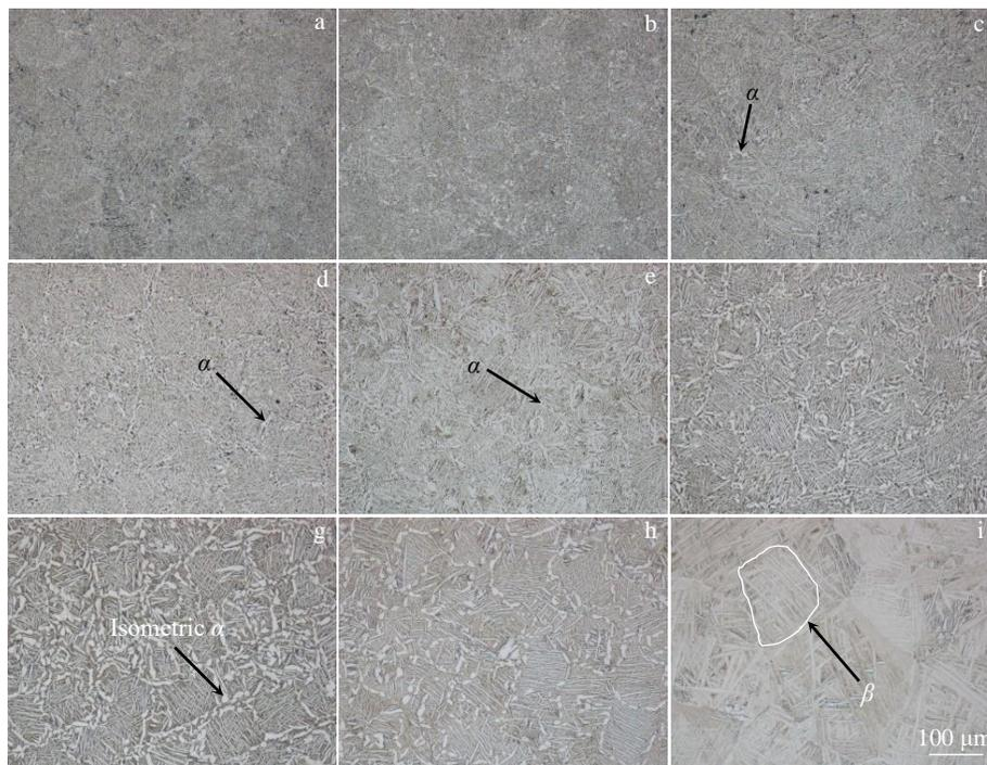
图5 不同固溶温度下SLM成形高温钛合金横截面金相组织
