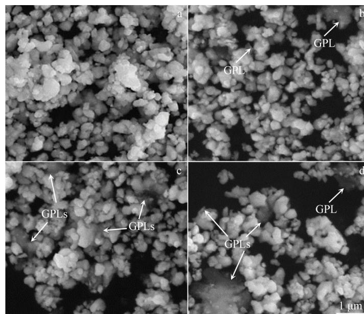
Fig.1 SEM images of powder mixtures of WC-Co-xGPLs cemented carbides after ball milling: (a)  $x=0$ ; (b)  $x=0.05\text{wt}\%$ ; (c)  $x=0.10\text{wt}\%$ ; (d)  $x=0.20\text{wt}\%$
