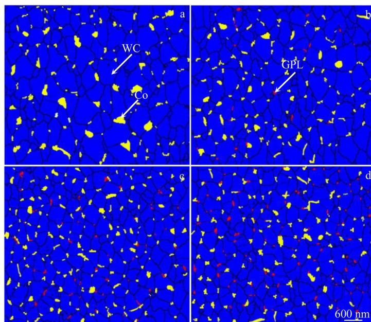
Fig.6 EBSD maps of WC-Co-xGPLs cemented carbides: (a)  $x=0$ ; (b)  $x=0.05\text{wt}\%$ ; (c)  $x=0.10\text{wt}\%$ ; (d)  $x=0.20\text{wt}\%$
