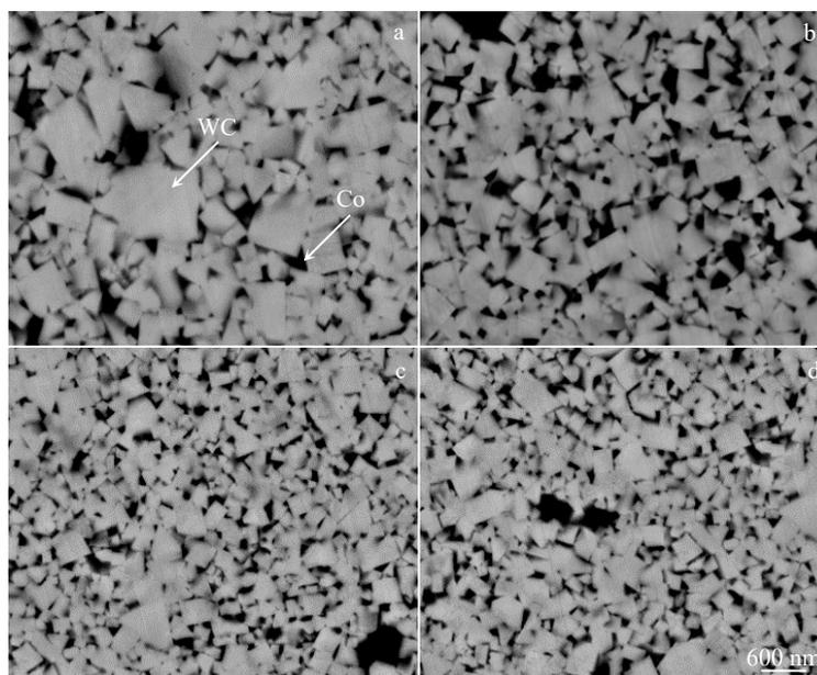
Fig.4 Surface morphologies of WC-8Co- $x$ GPLs cemented carbide after polishing: (a)  $x=0$ ; (b)  $x=0.05\text{wt}\%$ ; (c)  $x=0.10\text{wt}\%$ ; (d)  $x=0.20\text{wt}\%$
