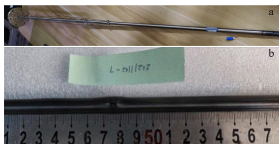
图10 自主化新型锆合金包壳高温爆破试验件
