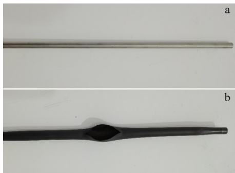
图5 自主化新型锆合金包壳高温塑性变形前后样品
