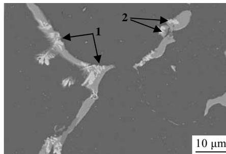
图 4  $Al_8Cu_4Er$  异质形核生长的 SEM 照片
