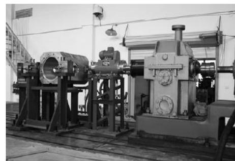
图 3 钛合金燃烧模拟试验平台
