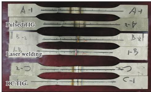
图6 TA18 钛合金焊接接头室温拉伸试样的照片
