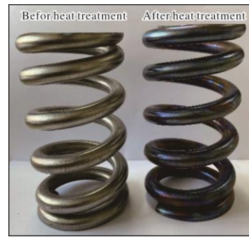
图 2 TB9 钛合金弹簧热处理前后的照片
