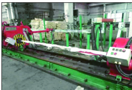
图6 冷却过程中采用石棉布包裹型材
